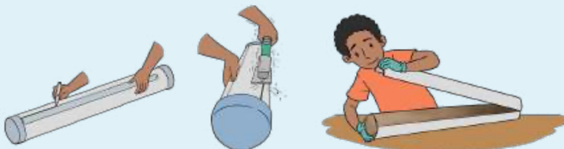
Gambar 6.5 Pipa dibelah dengan gerinda
