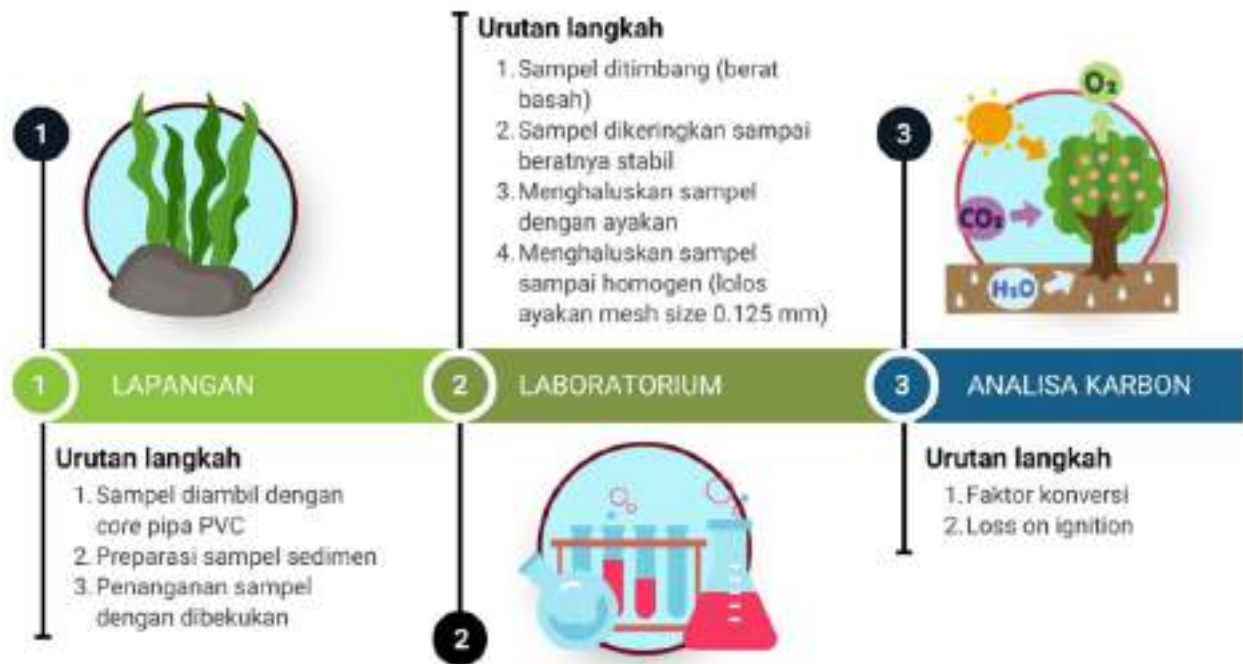
Gambar 7.3. Alur analisis sampel sedimen untuk pengukuran karbon organik
