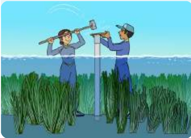
Gambar 6.1. Pipa PVC dipalu hingga tidak bisa turun masuk ke sedimen lebih dalam lagi
