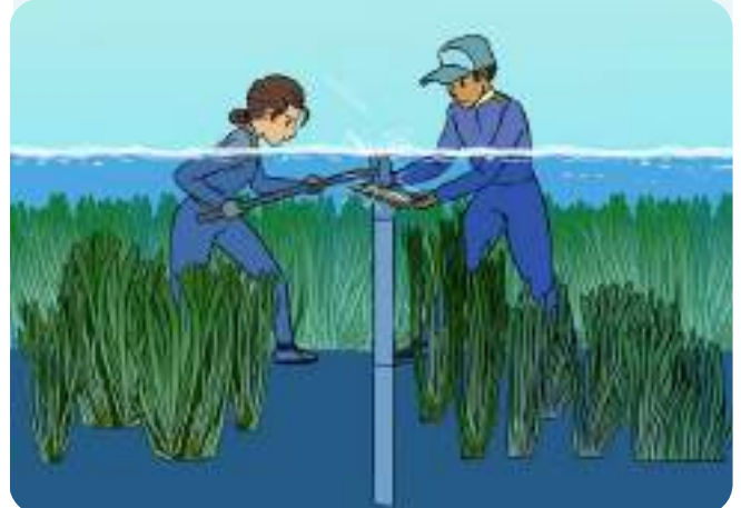
Gambar 6.1. Pipa PVC dipalu hingga tidak bisa turun masuk ke sedimen lebih dalam lagi
